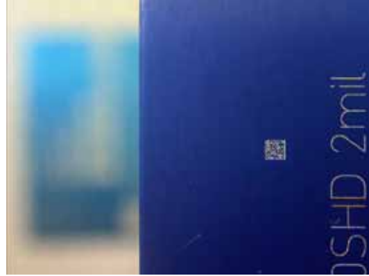
L'objectif liquide s'ajuste pour un petit code Data Matrix rapproché, ci-dessus, et ci-dessous il peut faire la mise au point sur des codes-barres éloignés.
